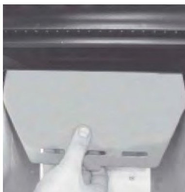
Slika 16: Zaokrenite zaštitni lim plamena
